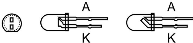
Fehlt eine eindeutige Kennzeichnung einer LED oder sind Sie sich mit der Polarität in Zweifel (da manche Hersteller unterschiedliche Kennzeichnungsmerkmale benutzen), so kann diese auch durch Probieren ermittelt werden. Dazu gehen Sie wie folgt vor: Man schließt die LED über einen Widerstand von ca. 270 Ω (bei Low-Current-LED 4 k Ω) an eine Betriebsspannung von ca. 5 V (4,5 V oder 9 V-Batterie) an.
